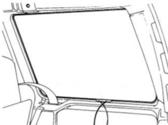
4. Positionnez la fenêtre avec le joint dans l'ouverture de la carrosserie. Les extrémités de la corde doivent se trouver à l'intérieur du véhicule.
